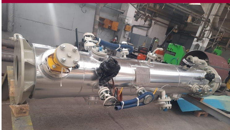
Wymiennik zaizolowany wełną mineralną i płaszczem z blachy
