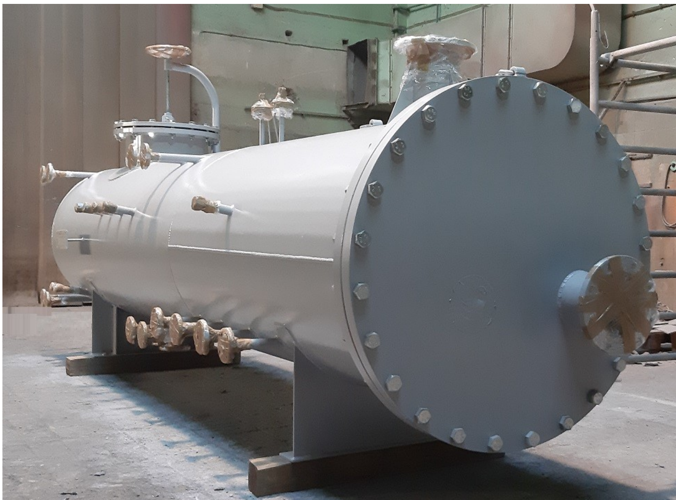
Układ R-301, Regenerator TEG-u
