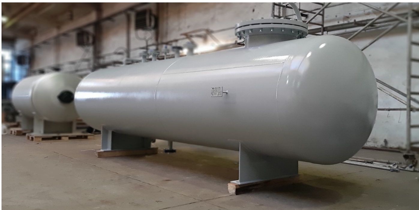
Zbiorniki magazynowy TEG-u
